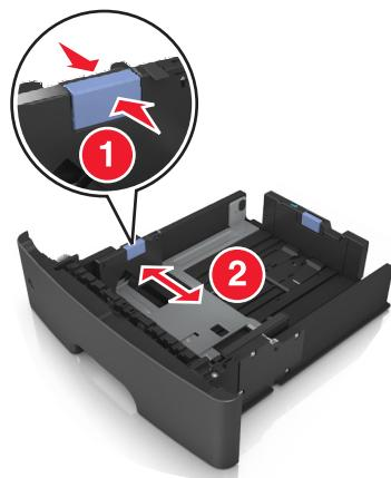
**3** Разблокируйте направляющую длины. Сожмите, а затем передвиньте направляющую длины в положение, соответствующее формату загружаемой бумаги.
